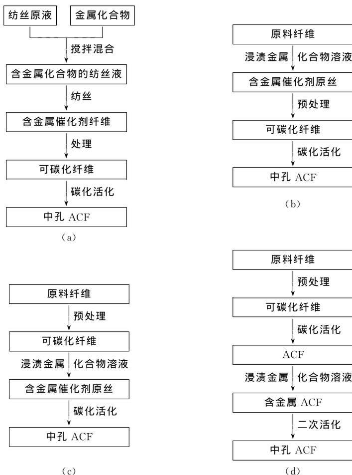
图 10-5 金属化合物催化活化法制备中孔 ACF 四种流程示意图
