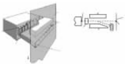
图 8-5 二元式喷印工作原理
