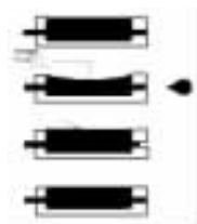
图 8-2 压电式 喷印工作原理
