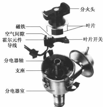
图 8.9 带霍尔效应传感器的分电器
