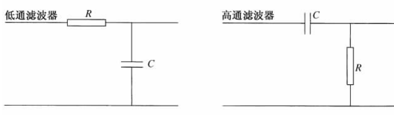
图 2.24 低通和高通滤波电路
