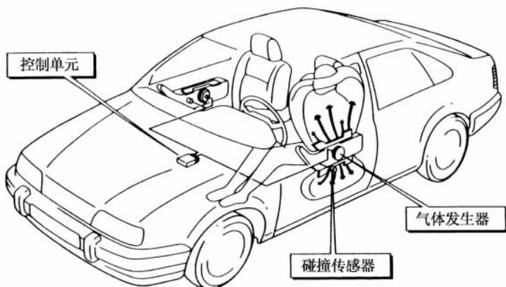
图 16.36 侧面安全气囊系统
