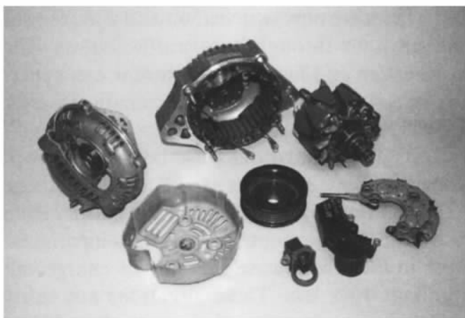
图 6.26 交流发电机元件组成
