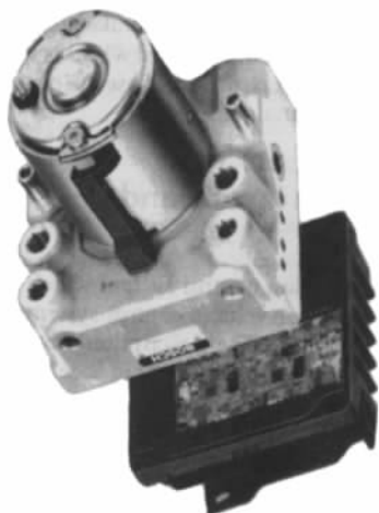
图 15.8 ABS、牵引控制 ECU 与压力调节器
