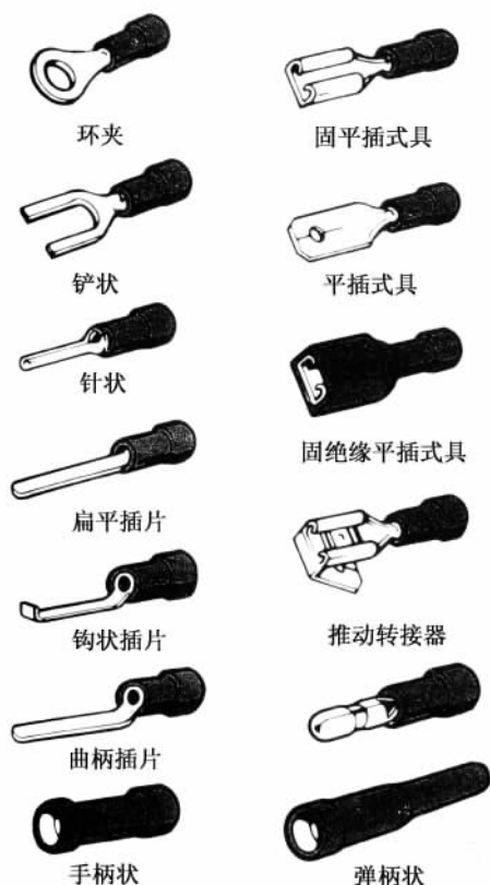
图 4.15 用于修理的挤压终端工具
