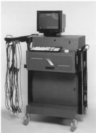
图 3.9 是一个“Sun”牌数字示波发动机分析仪,这种设备的许多组成部分前面已介绍过,下面是该分析仪的一些特别的属性:
