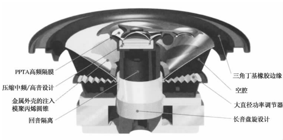
图 16.19 扬声器的基本构造
