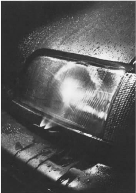
图 12.15 前大灯洗涤器喷水状态
