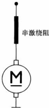
图 7.14 串激绕法电动机
