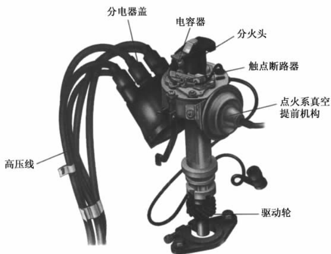
图 1.8 有触点式分电器
