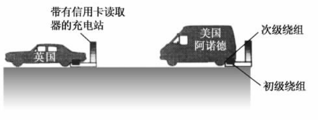
图 17.15 有助于电动汽车发展的感应充电技术
