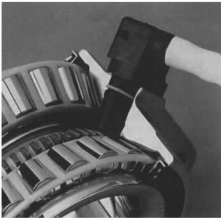
图 2.79 ABS 轮速测定中的霍尔效应传感器
