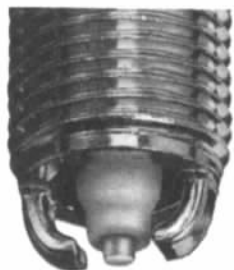
图 8.31 半面型火花塞具有良好的抗积炭性能
