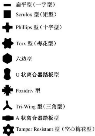
图 3.2 各种螺丝刀头部形状
