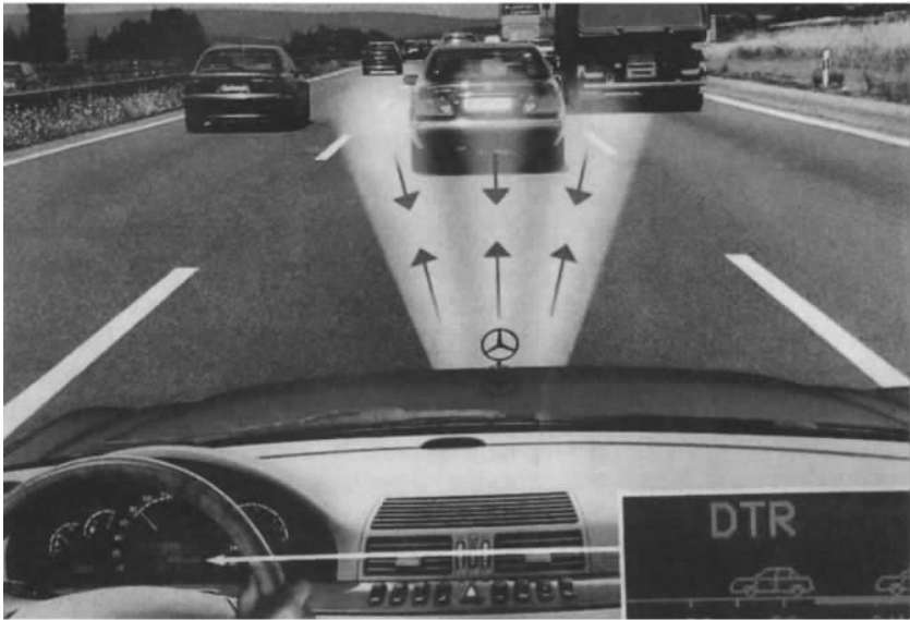
图 16.14 自适应巡航控制系统的操作
