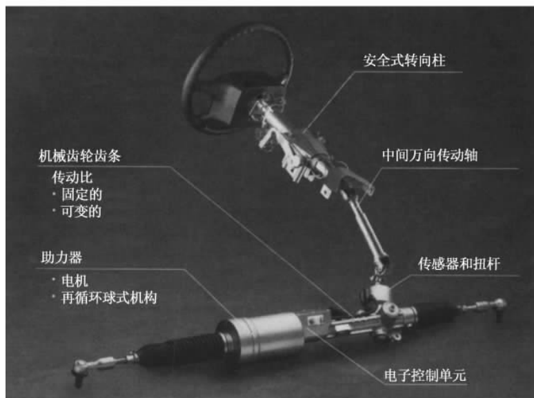
图 15.22 电控助力转向系统
