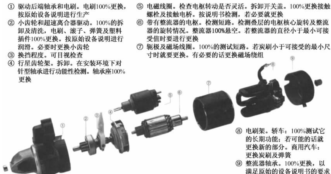
图 7.30 启动机大修程序
