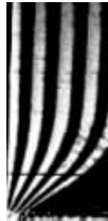
图 5.6 氢气泡时间线显示的层流边界层速度型
