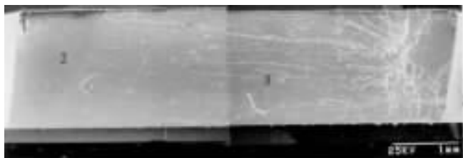
1—断裂源区(雾状区) 2—镜面区 3—粗糙区。
