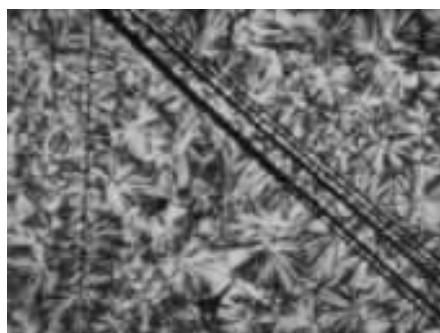
图 猿-猿 碳纤维在全同立构聚丁烯-员熔体结晶中的成核作用
