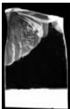
图猿-缘韵 双轴拉伸定向有机玻璃的 拉伸断口形貌
