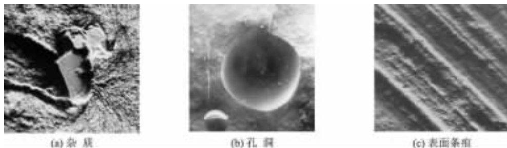
图 8-15 高聚物材料内缺陷举例 ( 扫描电镜照片 )
