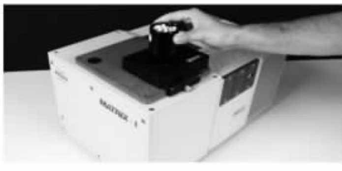
图 6-3 玉米样品的积分球漫反射测定
