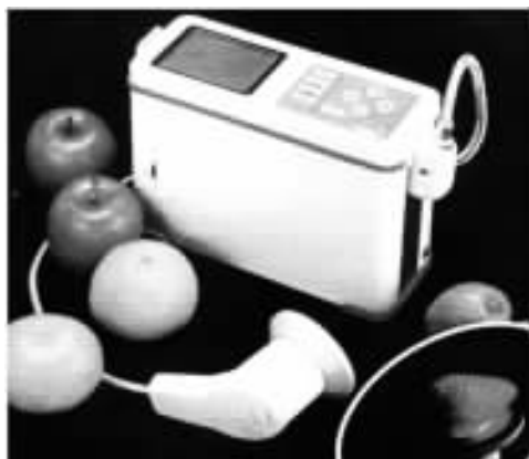
图 6-6 近红外光纤式漫反射法测柑橘糖度
