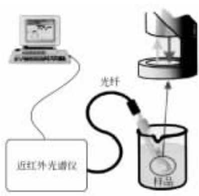
图 6-11 透射光纤采集液体近红外光谱
