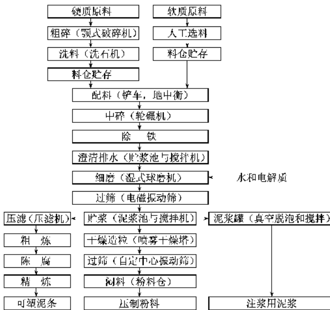
图 1-3-2 坯料制备的一般工艺流程
