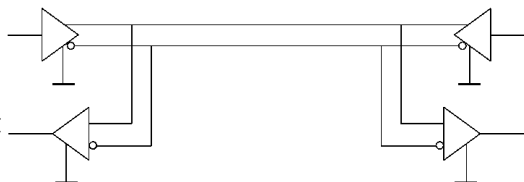
图 6-1 RS-485 通信接口电路原理示意图
