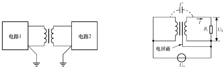
图 4-20 用隔离变压器阻隔地环路
