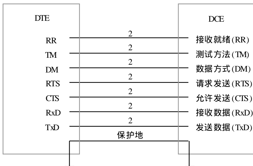
图 5.2 RS-449/ V.35 的一些主要控制信号
